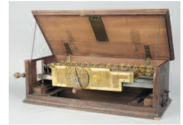
Vierspeziesrechenmaschine von Leibniz, GWLB
