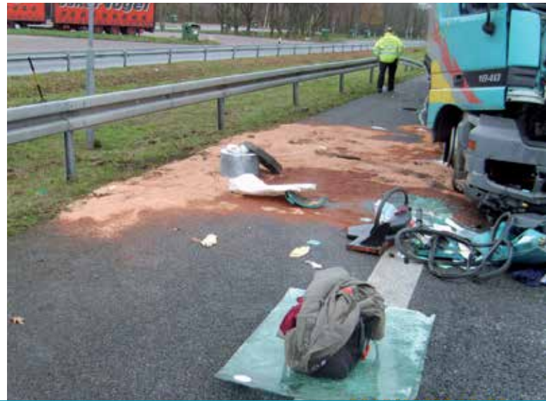
Diesel und Kühlwasser werden gebunden
