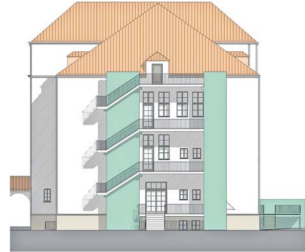
Nordseite: An der Rückfront des Gebäudes wird eine Treppen- und Fahrstuhlanlage angebaut – diese ist zugleich der zweite Fluchtweg aus dem Gebäude.
