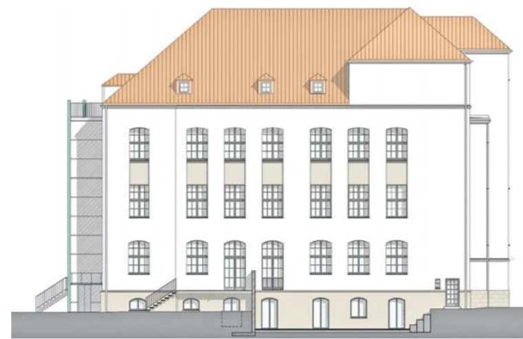
Westseite: Auf rund der Hälfte der Seitenfront wird das Gelände ein Stück weit abgetragen. So können in einigen Räumen im Erdgeschoss ebenerdige Ausgänge geschaffen werden.
