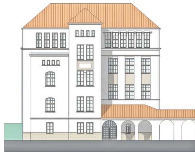
Südseite: Hier gibt es nur wenige Veränderungen. Die Fassade erhält teilweise eine Außendämmung, zudem werden die Fenster ausgewechselt.
