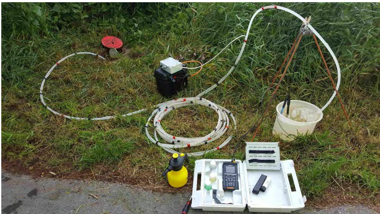
Messung von Temperatur, Leitfähigkeit und pH-Wert an einer Grundwassermessstelle (Foto: Lina-Marie Aethner)
